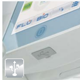
El puerto USB de la consola Full Touch ofrece al médico la posibilidad de guardar y cargar sus programaciones personales para el uso del equipo odontológico.
